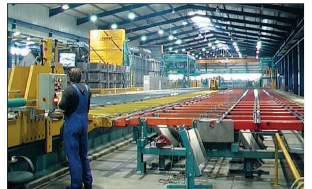
Aus den Aluminium-Rundbarren werden unter hohem Druck Strangpress-Profile in den unterschiedlichsten Formaten hergestellt.
