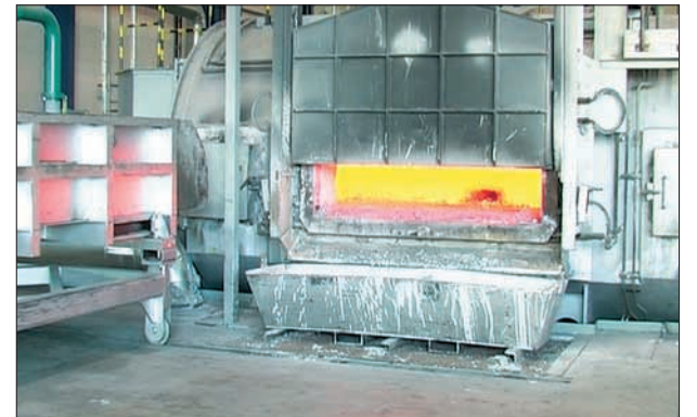
In der eigenen Gießerei werden das in der Produktion anfallende Restaluminium sowie zugekauftes Sekundäraluminium geschmolzen und zu Rundbarren für die Profilverstellung verarbeitet.
